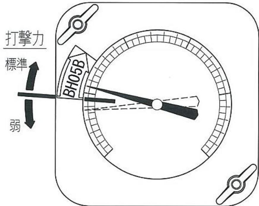
※) 弊社製品以外で打撃エネルギーが測定範囲内(10~30J)かつシャンク形状も純正工具を使用できる機種の判定基準につきましてはお客様にて基準をご決定ください。判定ラベル(無地)が付属していますので目盛盤に貼り付けてご使用ください。
