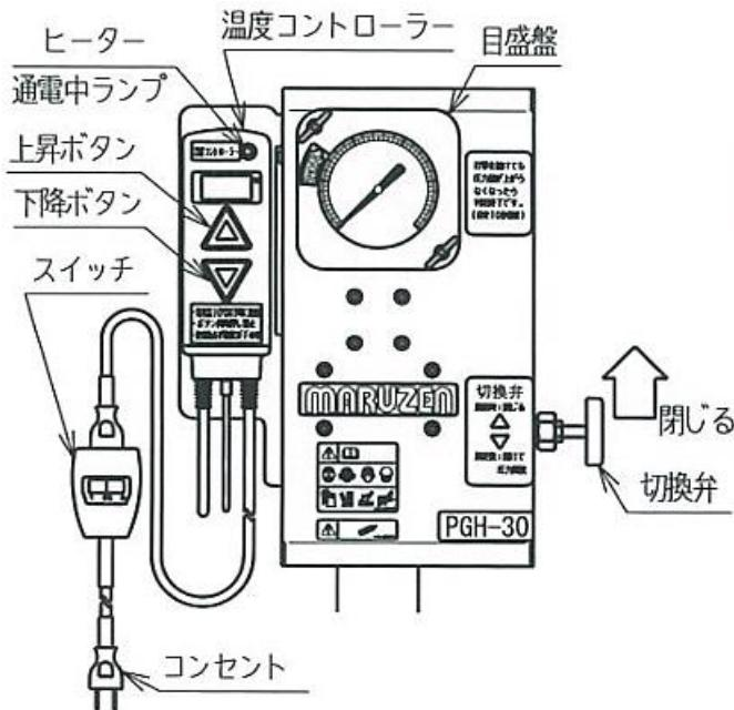
※) 寒い時期(外気温 10°C以下)はパワーチェッカーの暖機が必要です。温度コントローラーの電源を入れ加熱装置を使用し暖機してから測定を始めてください。
