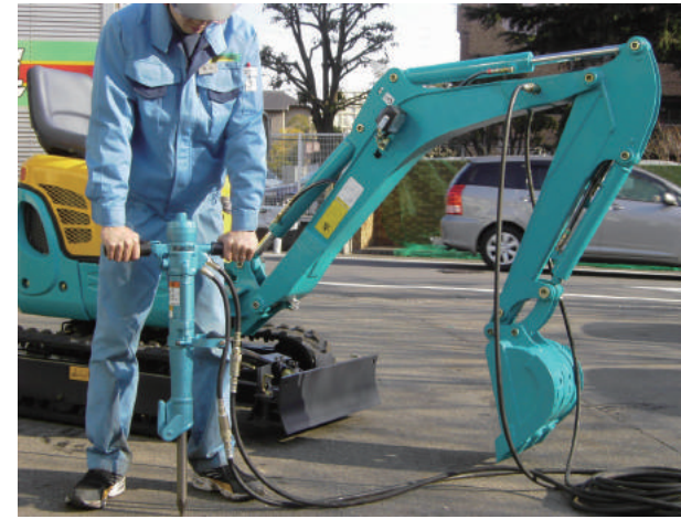
油圧ショベル、クレーン車などの建設車両からも油圧を取り出して、各種油圧ハンドブレーカが使用可能！
