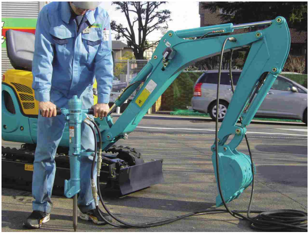
油圧ショベル、クレーン車などの建設車両からも油圧を取り出して、各種油圧ハンドブレーカが使用可能！
