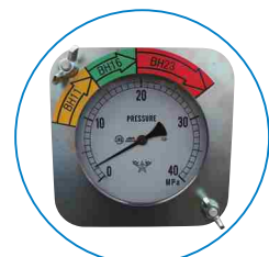
油圧計・目盛盤 (機種ごとの合格目盛で 打撃力を判定します。)
