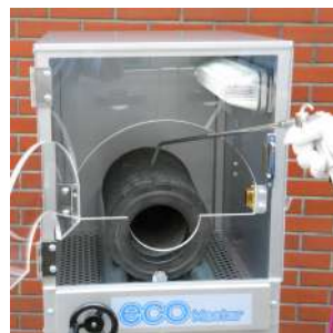
中扉を開け外側をブローします。
