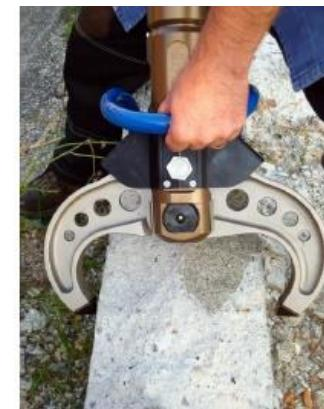
破碎能力を最大限引き出すために、製品を対象物に正しい向きで使用してください。
