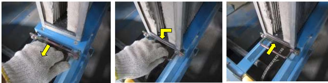
2. 左右の洗浄用エアノズルをフィルタから 10~20mm程度離れる位置にスライドして下さい。
