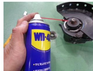
【写真7: 砥石取付ねじ部 への防錆剤塗布】
