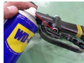
【写真6: スプールへの防錆剤塗布】
