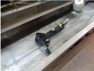
【写真1: 塩分や汚れの洗浄(水没)】
