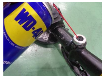
【写真5: 小穴への防錆剤塗布】
