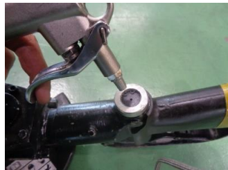
【写真2: 小穴のエアードライヤー】
