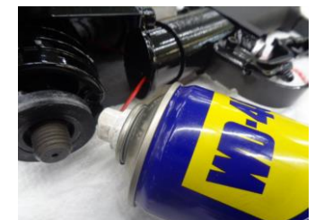
【写真8: ジョイントG小穴 への防錆剤塗布】
