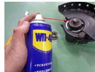
【写真6: 砥石取付ねじ部への防錆剤塗布】
