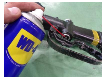
【写真5: スプールへの防錆剤塗布】
