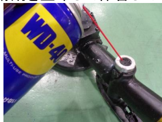
【写真4: 小穴への防錆剤塗布】
