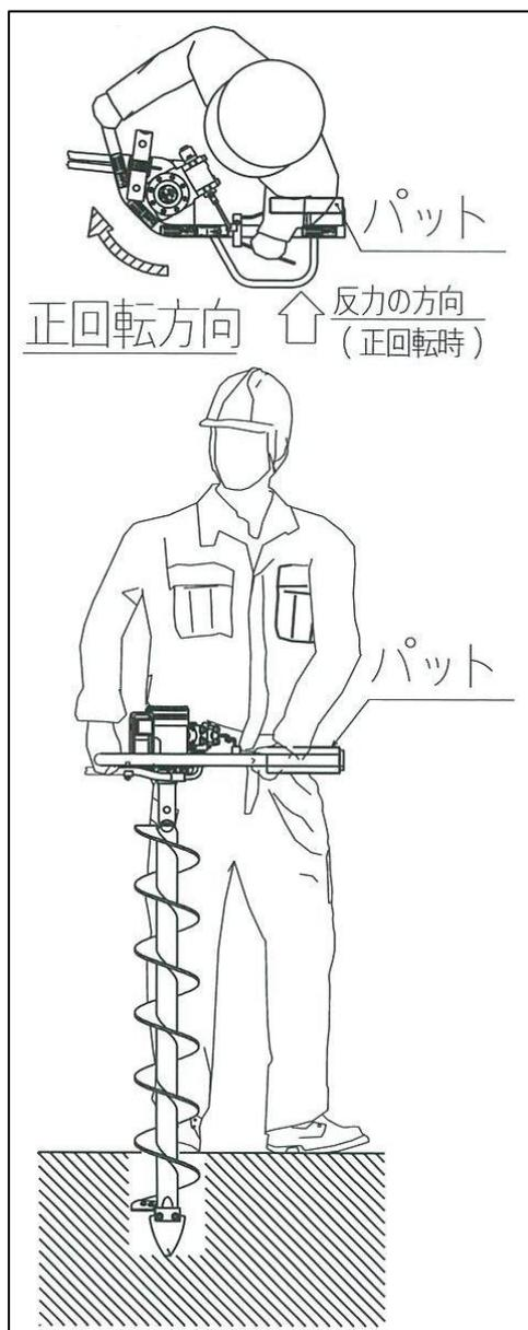
2. オーガーを垂直に立て徐々にレバーを握り回転数を上げて地面に小さな切り口を付けます。その後はレバーで回転数を調整しながら掘進してください。初めから最高回転数で使用すると土中に障害物があった場合、思わぬ力で反力を受けることがあります。操作になれるまでは低回転で作業し、1回目は低速で掘削して2回目は高速回転で土砂の放出する2段階作業が効果的です。
