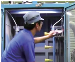
②洗浄装置内に粉塵が溜まった時は ブラシ等で清掃してください。
