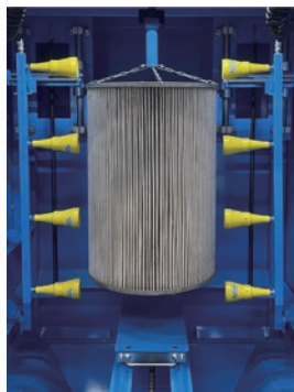
フィルターを吊り下げ スタート
