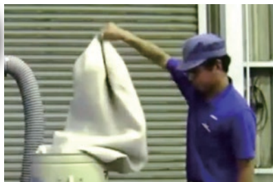
①定期的に集塵機の袋のゴミを 振り落としてください。
